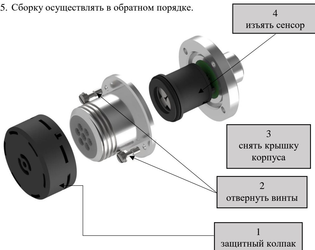
Рисунок 14 - Порядок замены оптического сенсора
